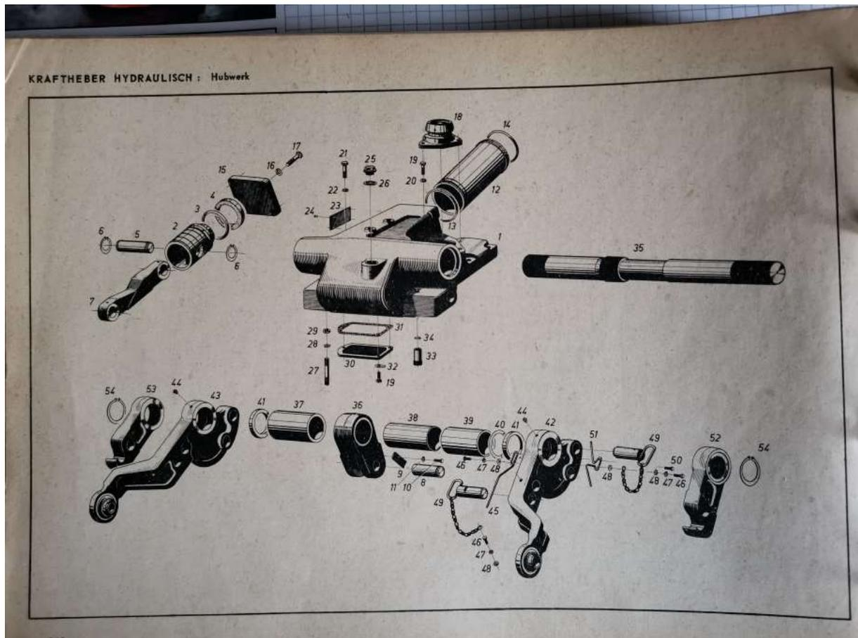
KRAFTHEBER HYDRAULISCH : Hubwerk
