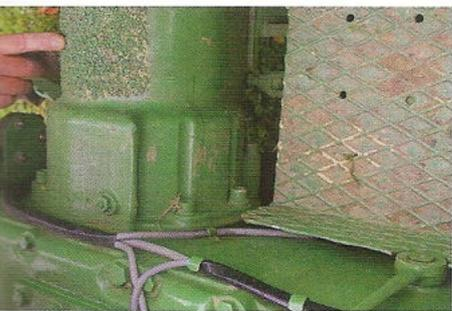
Guter Tip: Zur Verringerung der Rutschgefahr hat Norbert Danne einfach etwas Split auf den Achstrichtern einlackiert
