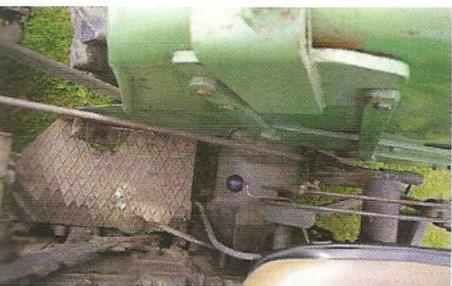
Die automatische Regelhydraulik mit dem Ausheber für das Mähwerk
