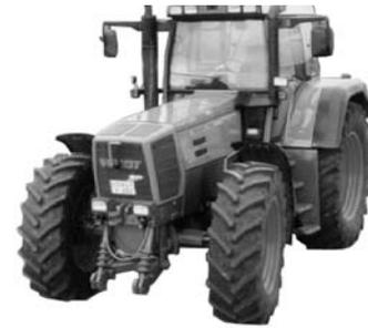
**ZUGLEISTUNG:** max. Leistung 104,3 kW bei 6,8 km/h und Motordrehzahl 1900 min<sup>-1</sup>, dabei 272 g/kWh, bei Nenn-drehzahl 99,4 kW bei 7,7 km/h, dabei 294 g/kWh.
